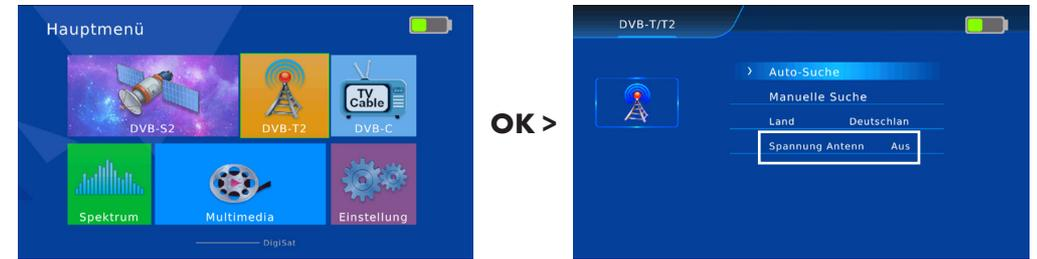
Aktive DVB-T2 Antennen benötigen meistens eine Betriebsspannung von 5V, die über das Antennenkabel zugeführt werden muss. Dies lässt sich über den Menüpunkt **Spannung Antenne Ein** vornehmen.
