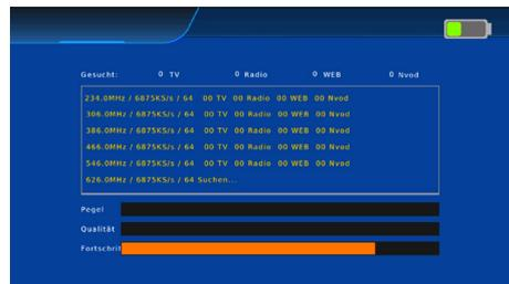
Über die Funktion **Manuelle Suche** kann jeder einzelne Kanal hinsichtlich seines Pegels, seines Signal-Rauschverhältnisses (**SNR**), des Bitfehlerverhältnisses (**BER**), der Symbolrate (SR) und des Typs der Quadratur-Amplituden –Modulation (**QAM Type**) dargestellt werden.
