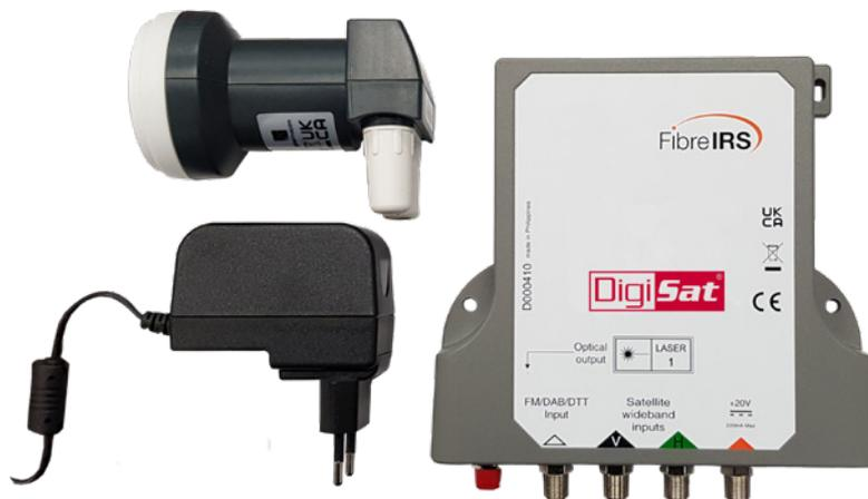
Das GDO 3 Set besteht aus einem Wideband-LNB und dem SAT-LWL-Sender einschließlich des Steckernetzteils. Diese Sendeeinheit ermöglicht die Verteilung der vertikalen und horizontalen SAT-Bänder in Kombination mit terrestrischen Rundfunkkanälen über ein Glasfasernetz (LWL) an eine große Anzahl von Gebäuden und Haushalten. Die Sendeeinheit kann im Innen- oder Außenbereich montiert werden.
